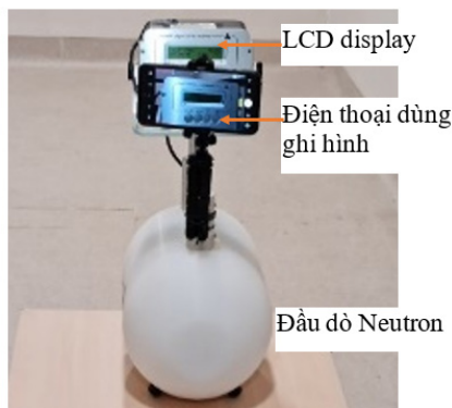
Hình 4: Sử dụng camera điện thoại di động để ghi lại màn hình LCD của đầu dò neutron
